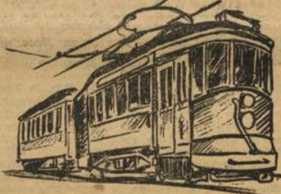
Straßenbahnwagen für Schweden. Türen und klappbare Trittbretter werden mittels Druckluft vom Führer betätigt. Ein Auf- oder Abspringen während der Fahrt ist unmöglich
