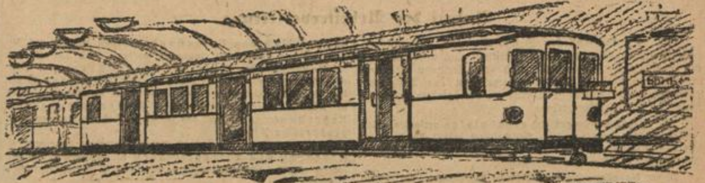
Jeder Wagen 18 m lang, d. h. ca. 5 m länger als die bisher gebräuchlichen. — Vom Führerstand aus selbsttätig schließende Türen. — Verletzungen durch Einklemmen unmöglich.
