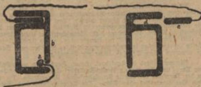
Abb. 3: Die Befestigung der Spritzwasserdecke.
