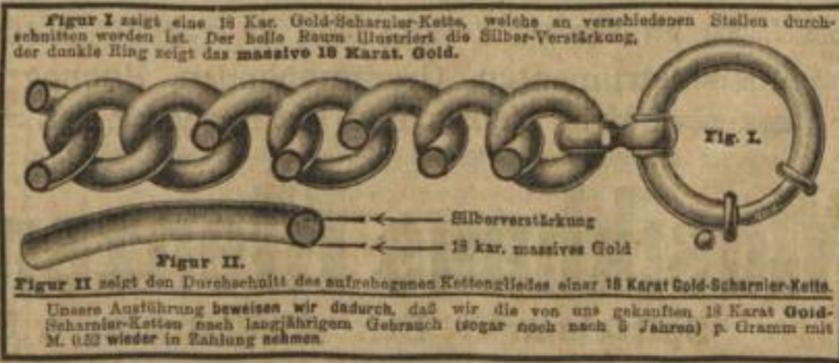
Figur I zeigt eine 18 Kar. Gold-Scharnier-Kette, welche an verschiedenen Stellen durchschnitten worden ist. Der helle Raum illustriert die Silber-Verstärkung, der dunkle Ring zeigt das massive 18 Karat. Gold.
